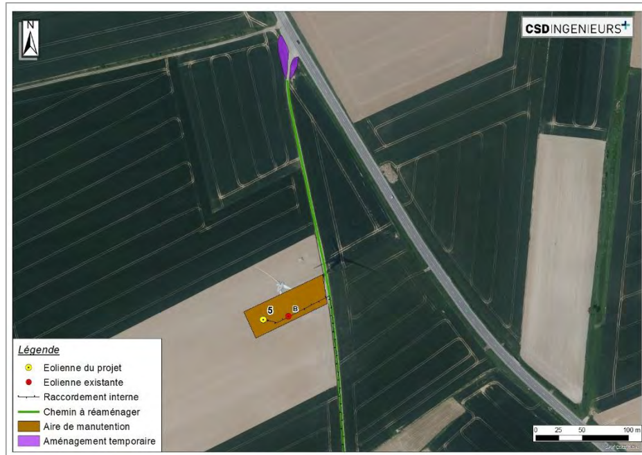
Figure 57 : Aménagements liés à l'éolienne n°5.
