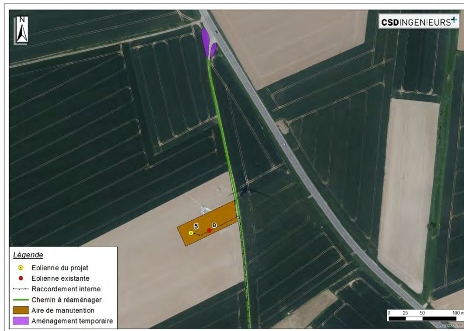
Figure 57 : Aménagements liés à l'éolienne n°5.
